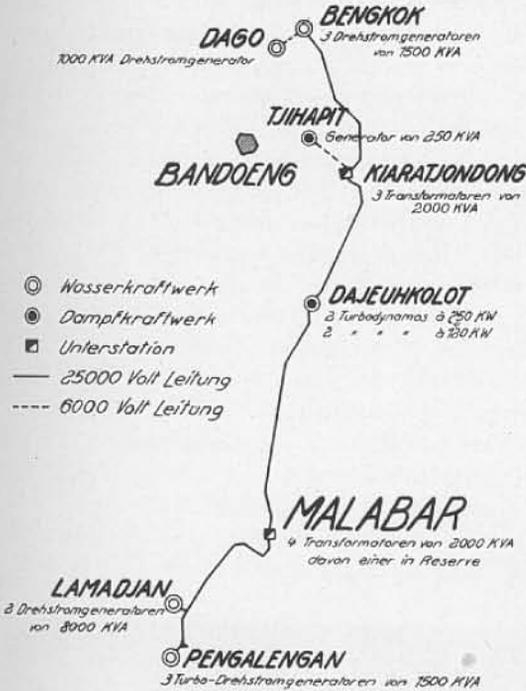
Bild 19. Stromversorgung von «Radio Malabar».
