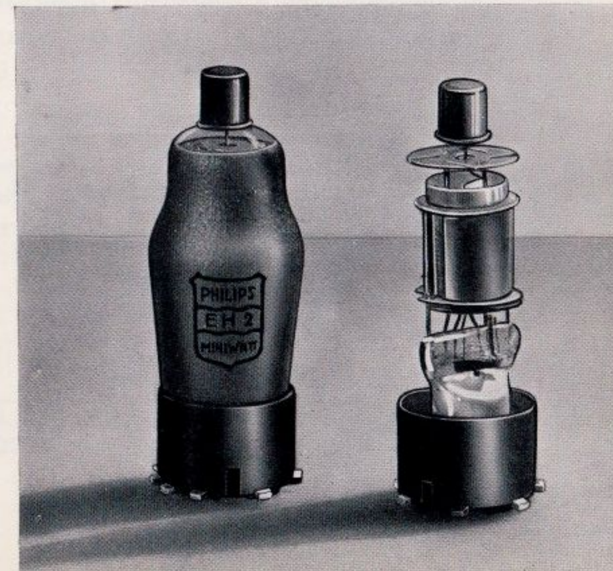
Schematische voorstelling van de heptode EH 2, benevens schema van aansluiting der elektroden aan de huls. Het stuurrooster is met de topaansluiting van den ballon verbonden.
