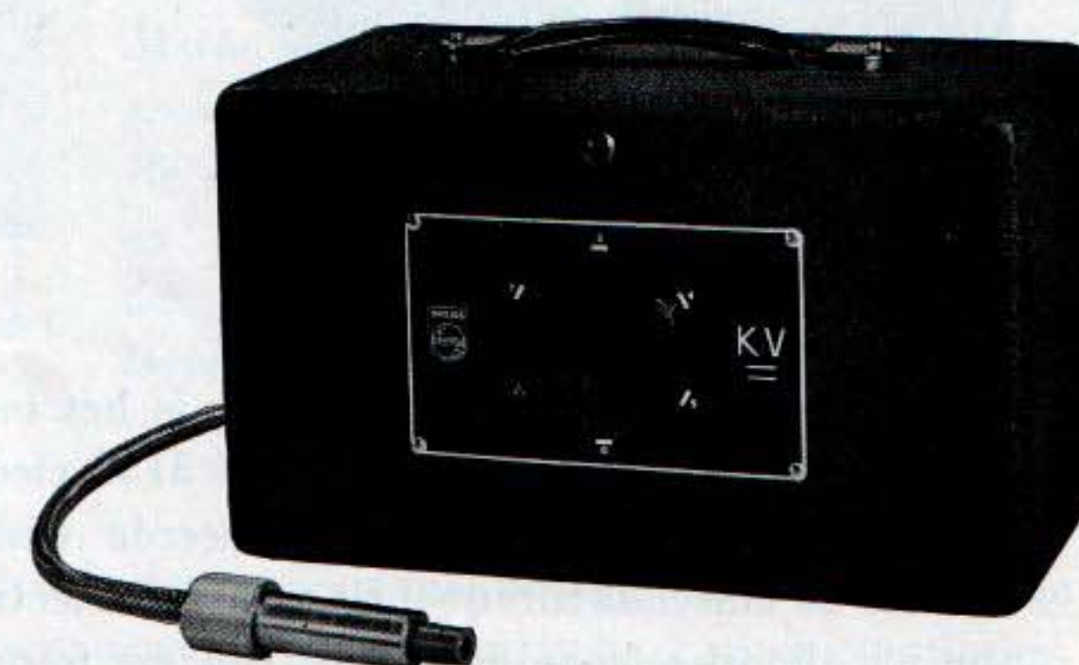
Fig. 16 5000 V-voedingsapparaat GM 4198 voor de naversnelling. De hoogspanning is instelbaar in 5 trappen van 1000 tot 5000 V.
