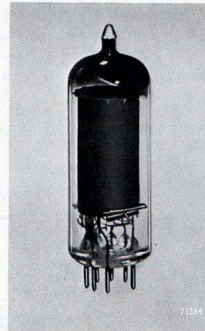
Fig. 26. The triode heptode ECH 81.
